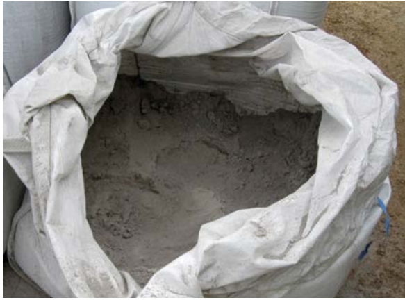
Cuncha tras ser lavada, quentada a 500°C e moída
