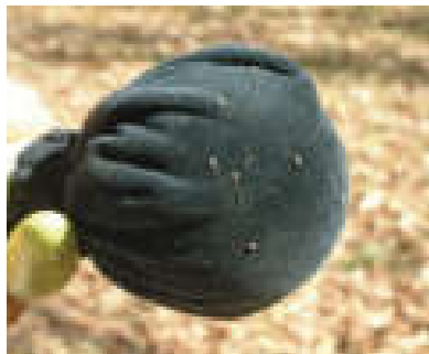
Test do tecido. Detalle dos aguillóns cravados na bóla da tea
