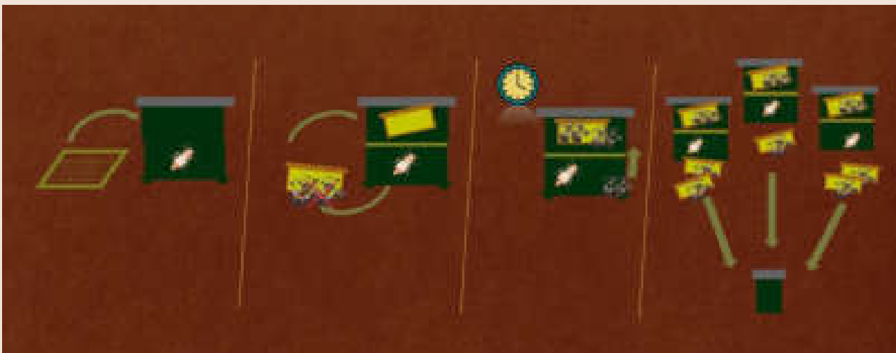
Sistema para evitar a retirada accidental de mestras nas colonias doantes
