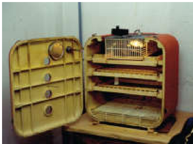
A incubadora proporciona nacementos moi regulares ao optimizar a temperatura e a humidade
